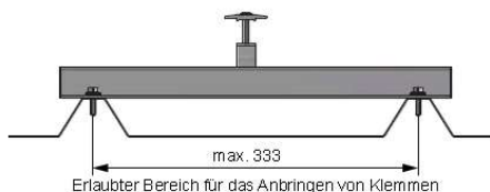
Abbildung 2: Klemmbereich auf Trapezschiene
